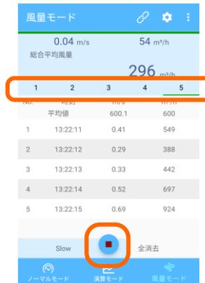
設定した回数の計測を終えると停止し、各ポイントタグのリストにデータが記憶され、次のポイントに移動します。
